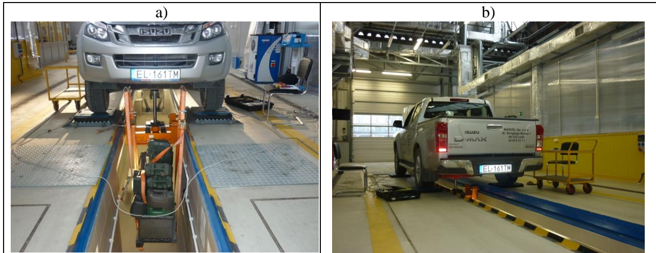
Rys. 7. Widok obiektu badań podczas wyznaczania charakterystyk sprężysto-tłumiących zawieszenia: a) przedniego b) tylnego
