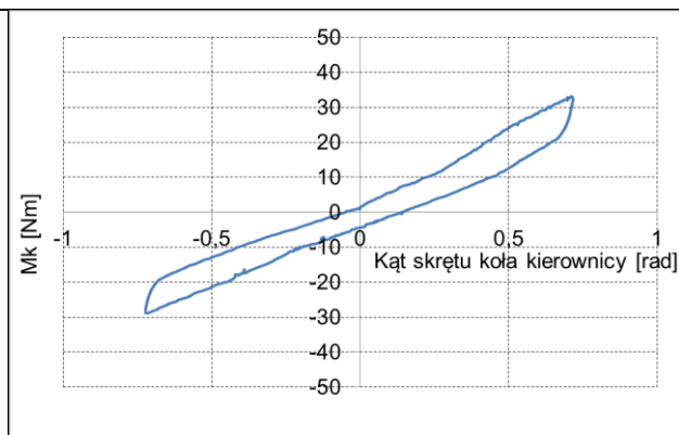
Rys. 13b. Charakterystyka podatności układu kierowniczego, prawe przednie koło jezdne unieruchomione, wartości kątów w radianach
