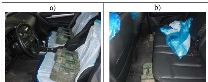
Rys. 1. Widok sposobu rozmieszczenia pojemników ze śrutem (zgodnie z p. 4.1.2), a) widok przednich foteli: kierowcy i pasażera, b) widok podłogi za przednimi fotelami
